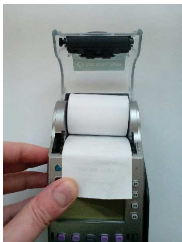
Рисунок 4. Загрузка рулона в лоток принтера
